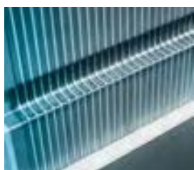
Surfaces d'échange du module pile à combustible
