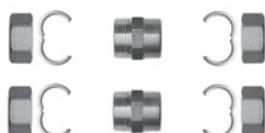
В комплекте соединения - 4 стопорных кольца, 4 накидные гайки, 2 ниппеля (HP x HP DN 12-25) с конической фаской и впрессованным фторопластовым уплотнением конической формы. Материал - латунь.
