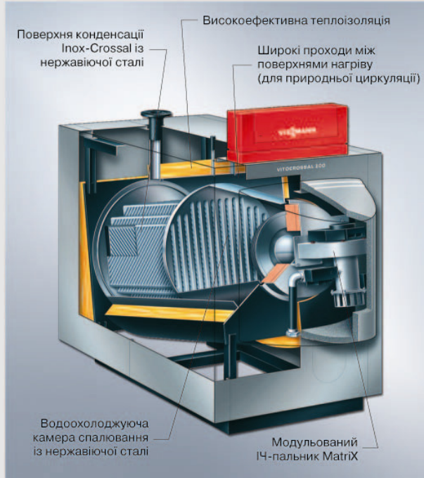
Газовий конденсаційний котел Vitocrossal 200 у розрізі
