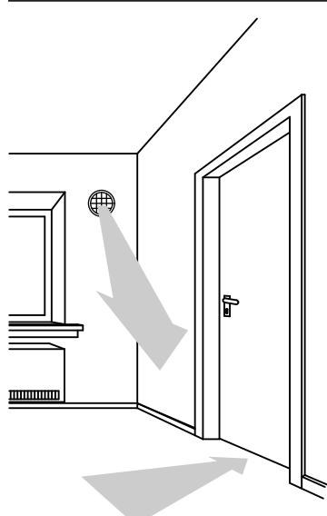
Для потока воздуха из зон приточной вентиляции (помещения с приточным элементом) в зоны вытяжной вентиляции необходима система связанных помещений.
