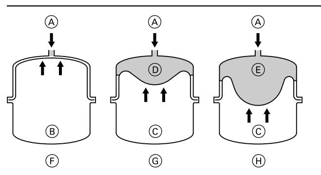
Расширительный бак гелиоустановки представляет собой закрытый бак, газовый объем которого (азот) отделен от жидкостного объема (теплоносителя) мембраной и давление на входе которого зависит от высоты установки.
