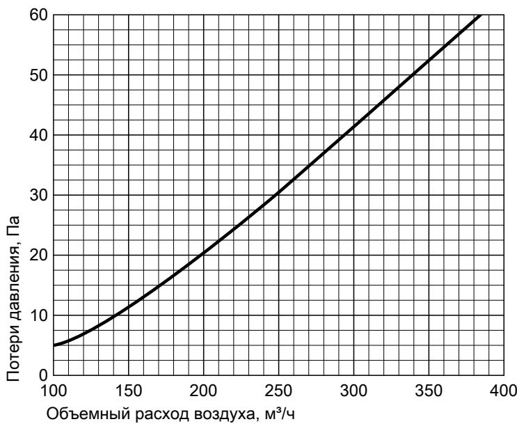
Вытяжной проход через кровлю
