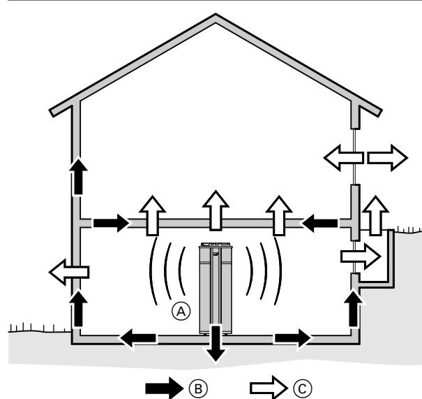
Распространение звука в зданиях происходит, как правило, в виде корпусных шумов через пол, стены и перекрытия. Шумовыделения в световых шахтах зачастую приводят к помехам не только в окружающей среде, но и в собственном жилом доме. Так, при неблагоприятных граничных условиях шумовое воздействие через окна может проникнуть в дом. В доме имеется опасность передачи воздушных шумов, в числе прочего, через лестничную клетку и подвальное перекрытие.
