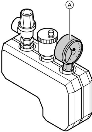
1. Проверить давление отопительной установки по манометру (A): Если стрелка находится ниже красной отметки, то давление установки слишком низкое (минимальное давление установки - 1,0 бар). В этом случае добавить в установку воды или обратиться в местную специализированную фирму-специалиста по отопительной технике.
