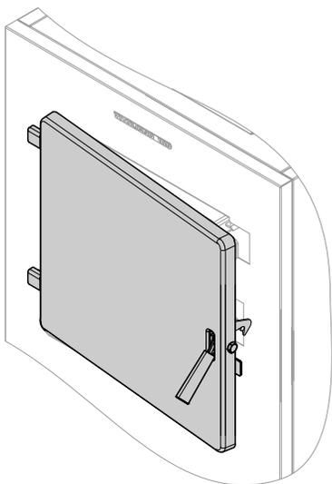
8. Закрыть заслонку полукоксового газа и загрузочную дверцу **только** до защелкивания блокировки.
