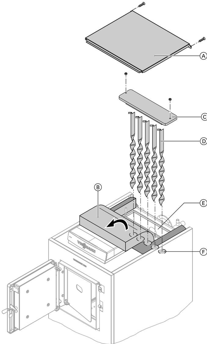
1. Снять заднюю часть верхнего щитка (A).
