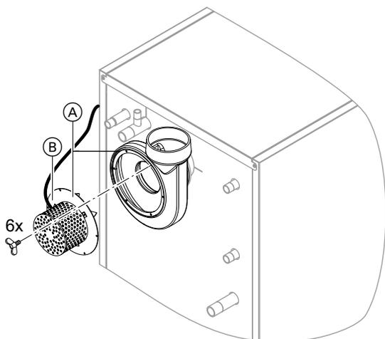
1. Ослабить барашковые винты на дымососе (А) и вытащить мотор (В) с крыльчаткой вентилятора.
