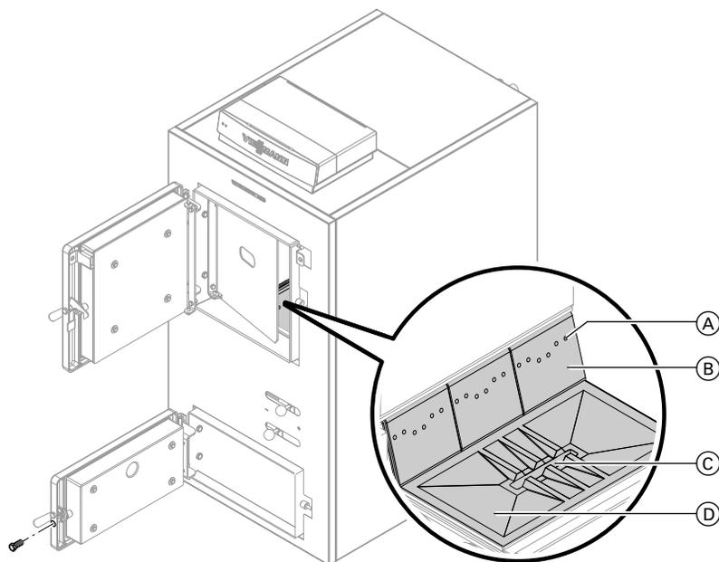
2. Отверстия первичного воздуха (A) в боковых элементах первичного воздуха (B) и паз жиклера (C) в нижнем элементе (D) следует очищать осторожно.
